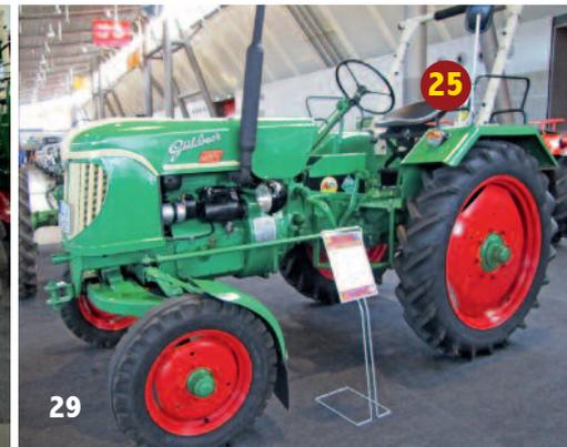
schaute es sich am Güldner A2K Spesart an. Der Güldner Motor 2 LKN kommt ohne Kühlgebläse aus, die Kühlluft wird direkt vom Schwungrad geliefert (27-29).
