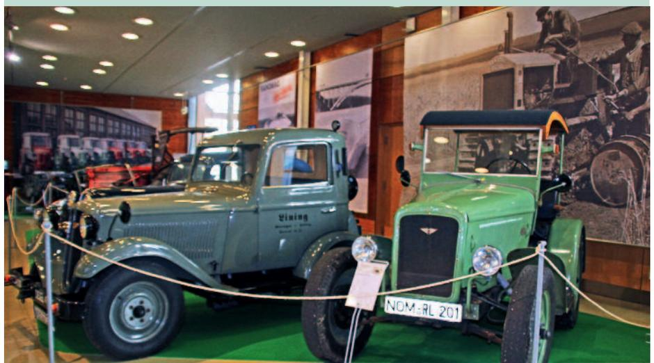
**RL 20-Bauernschlepper, ST 20-Straßenzugmaschinen und Rekord-Diesel-Pkw wurden ab 1937 alle mit dem 1,9-Liter-Hanomag-Dieselmotor gebaut.**
