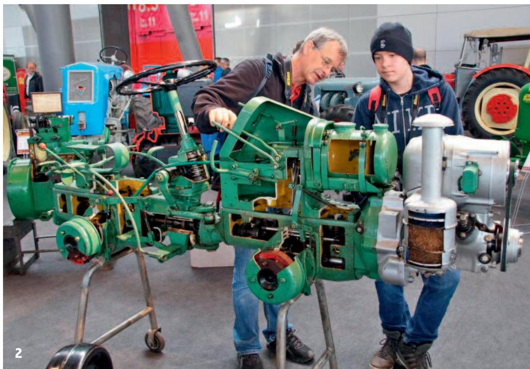
keit, deren Funktion zu verstehen. Sonst sind das ja nur geschlossene Kisten.“ Einige der didaktischen Modelle waren sogar elektrifiziert. So bewegten sich zum Beispiel die Kolben oder der ganze Antriebsstrang mit den zahlreichen Wellen und Zahnrädern der Getriebe (1/2).
